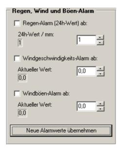
Mit Drücken der Schaltfläche "Neue Alarmwerte übernehmen" werden die Einstellungen an das Gerät übertragen, ansonsten erfolgt keine Reaktion.
