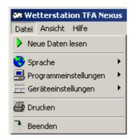
**Neue Daten lesen** Prüft, ob neue Daten im Gerät vorliegen und liest diese ein (wird normalerweise
